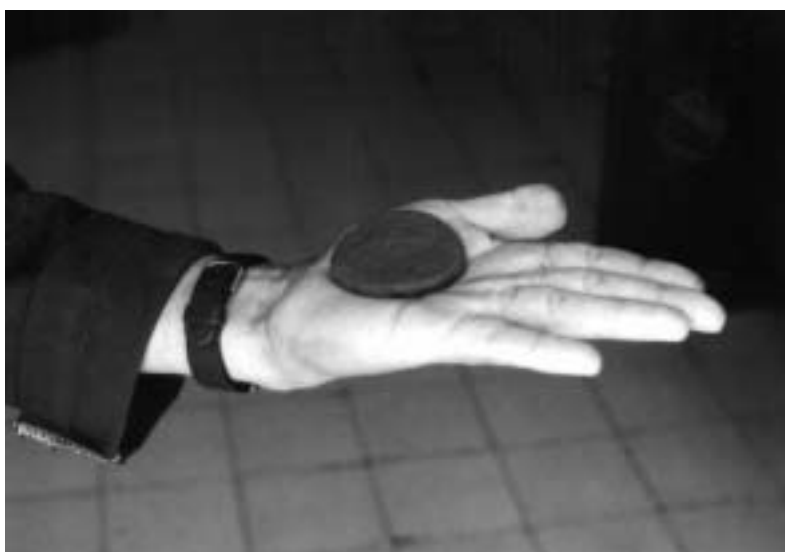
FIGURA 2.- Formación de la pastilla de prueba para determinar la dilatancia
