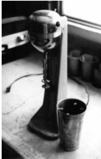
FIGURA 4.- Batidora para la preparación de la muestra de suelos arcillosos o cohesivos
