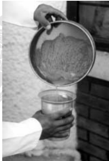
FIGURA 4.- El material retenido en la malla es devuelto al vaso metálico
