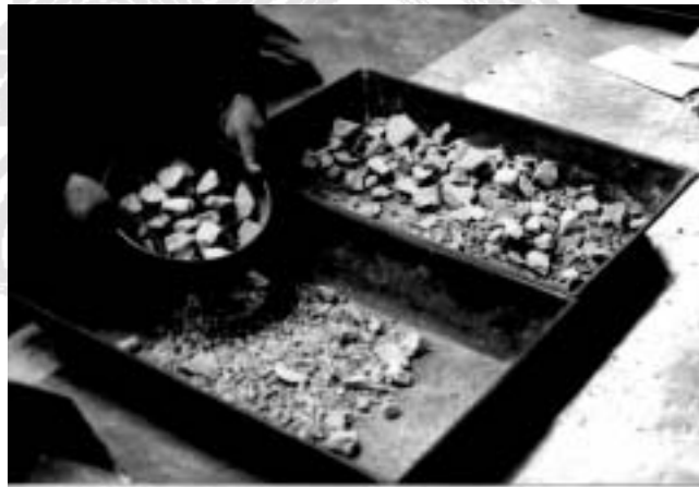
FIGURA 1.- Cribado del material a través de una malla
