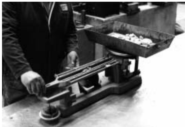
FIGURA 2.- Determinación de la masa de la fracción retenida en la malla
