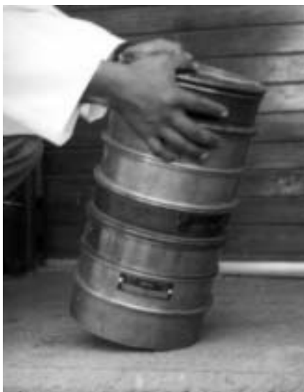
FIGURA 5.- Disposición de las mallas para efectuar el cribado de material que pasó la malla N°4
