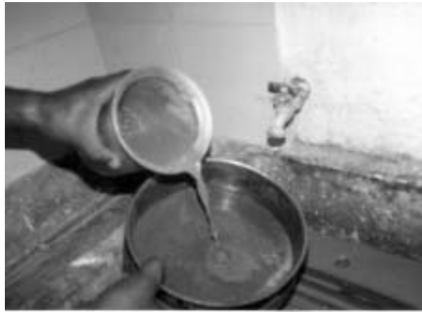
FIGURA 3.- Decantado de la suspensión a través de la malla N°200
