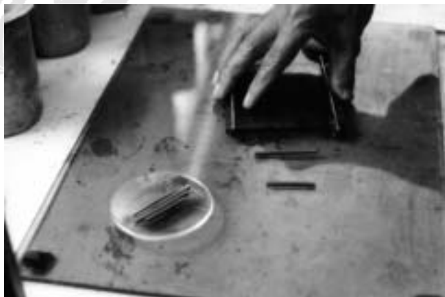
FIGURA 6.- Operación para formar el cilindro de material en la determinación de límite plástico
