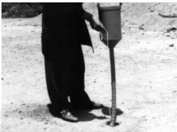
FIGURA 8.- Operación de llenado con arena de la cala de prueba
