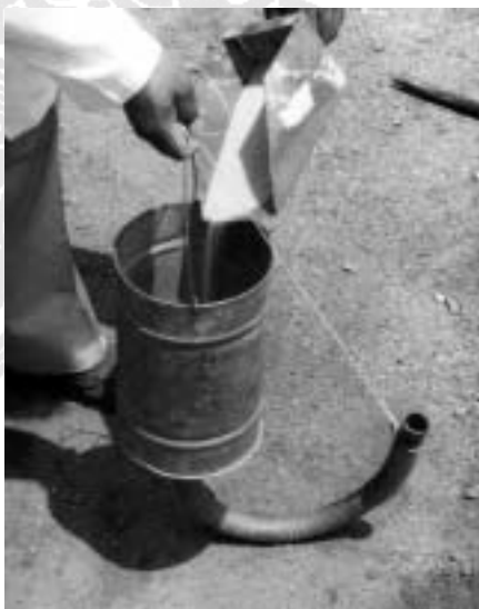
FIGURA 7.- Colocación de la arena en el dispositivo
