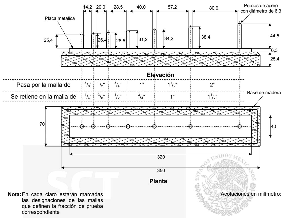
FIGURA 2.- Calibrador de longitudes
