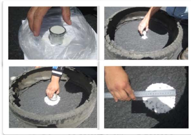
FIGURA 3.- Procedimiento de medición de Macrotextura
