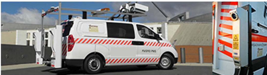
FIGURA 1.- Equipo óptico láser, acoplado en vehículo
