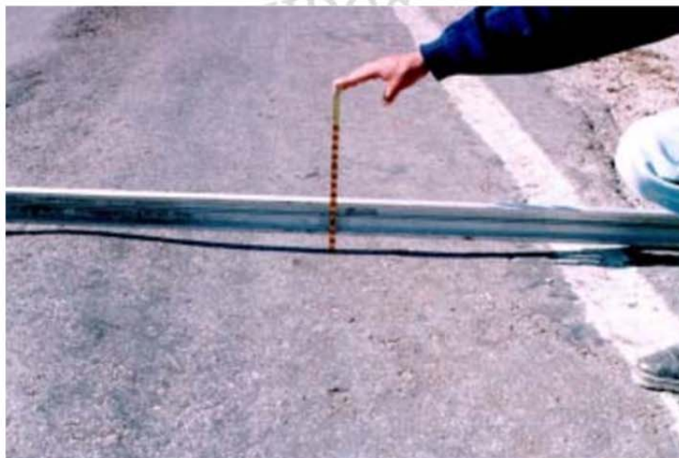
FIGURA 1.- Equipo para la determinación de la profundidad de rodera
