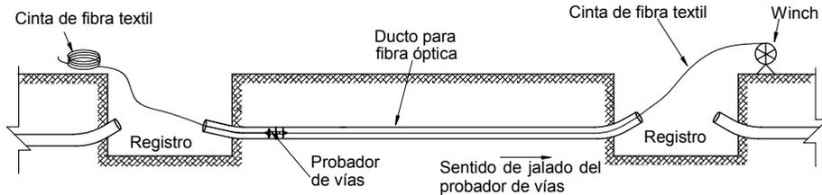
FIGURA 7.- Procedimiento para la prueba de vía
