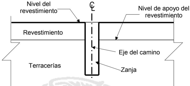
FIGURA 4.- Posición del eje del poliducto en caminos rurales
