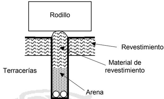
FIGURA 5.- Compactación mecánica del relleno
