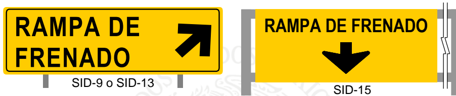
FIGURA 5.- Señales informativas de destino (SID) especiales de rampas para frenado de emergencia
