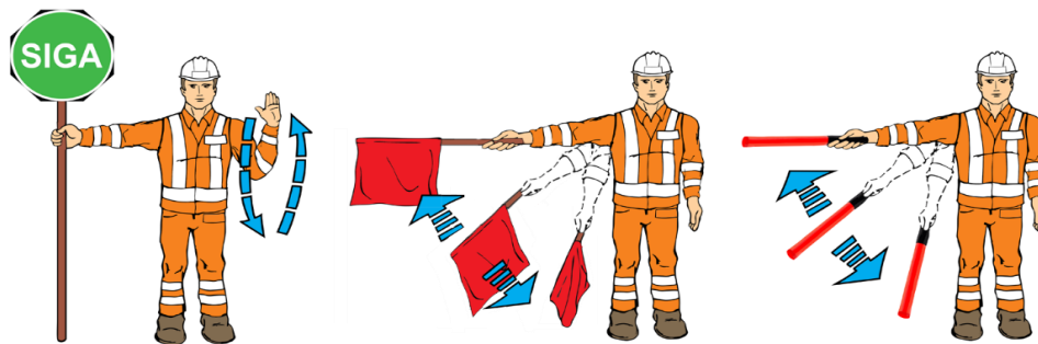
Alertar y disminuir la velocidad del tránsito
