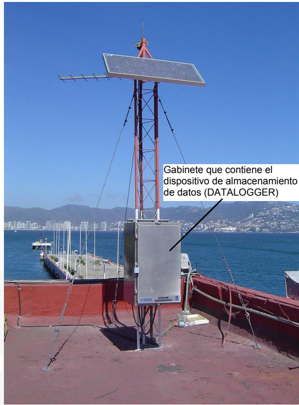
FIGURA 10.- Antena transmisora y gabinete que contiene el dispositivo de almacenamiento de datos (DATALOGGER) (detalle del gabinete se muestra en la Figura 11)
