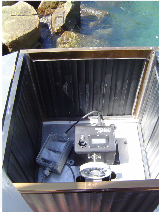
FIGURA 12.- Sensor de flotador colocado en la caja
