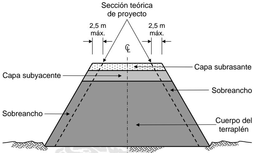
FIGURA 1.- Sección transversal de un terraplén sobre el que se desplantará un pavimento
