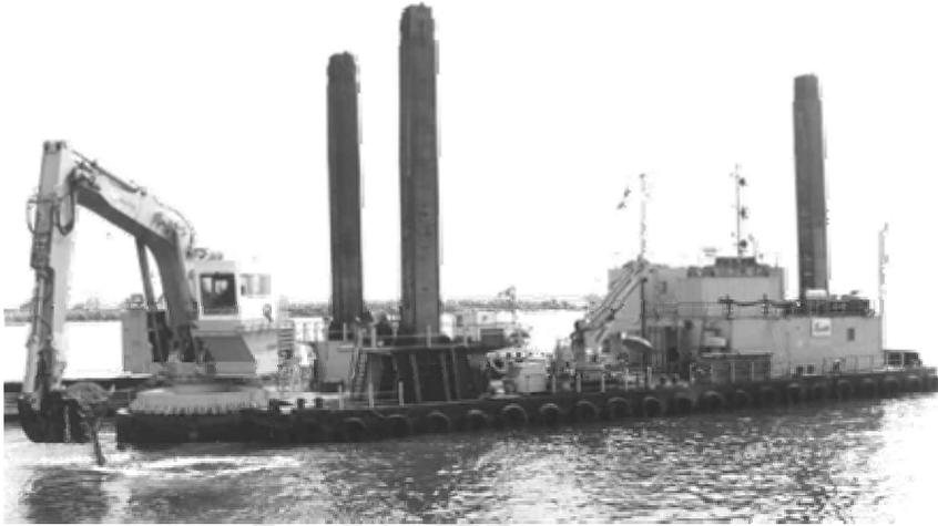
FIGURA 4.- Draga estacionaria mecánica con retroexcavadora
