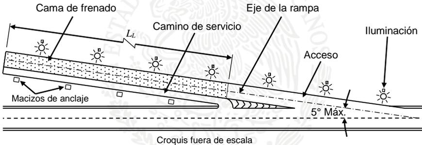
FIGURA 1.- Rampa para frenado de emergencia. Disposición en planta
