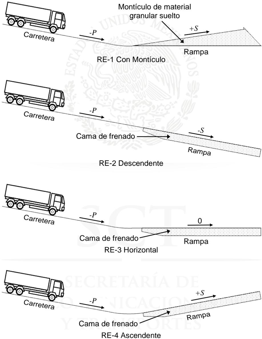
FIGURA 2.- Tipos de rampas para frenado de emergencia (RE)
