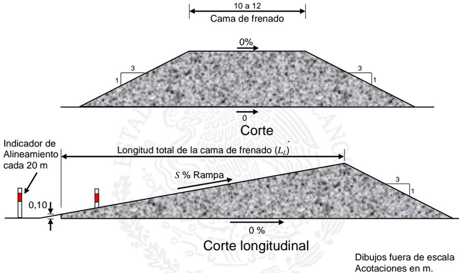
FIGURA 3.- Disposición en corte de las rampas para frenado de emergencia tipo RE-1
