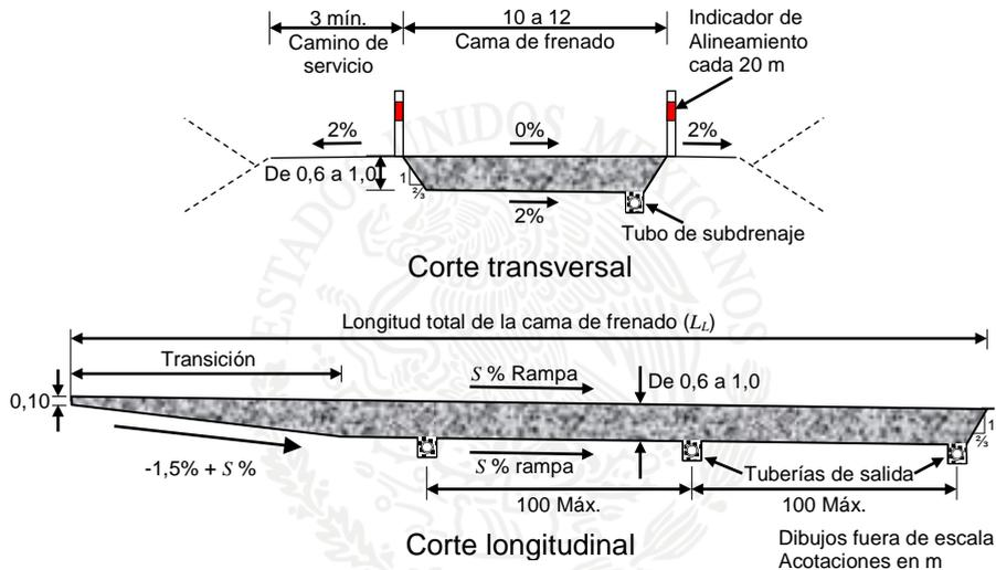
FIGURA 4.- Disposición en corte de la cama de frenado de rampas para frenado emergencia tipos RE-2, RE-3 y RE-4
