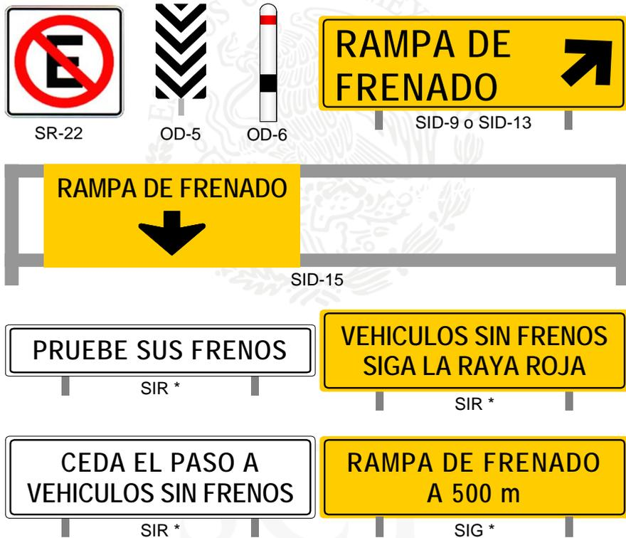
FIGURA 7.- Señales verticales de rampas para frenado de emergencia
