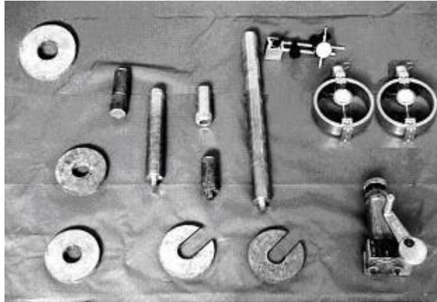
FIGURA 1.- Equipo portátil de carga
