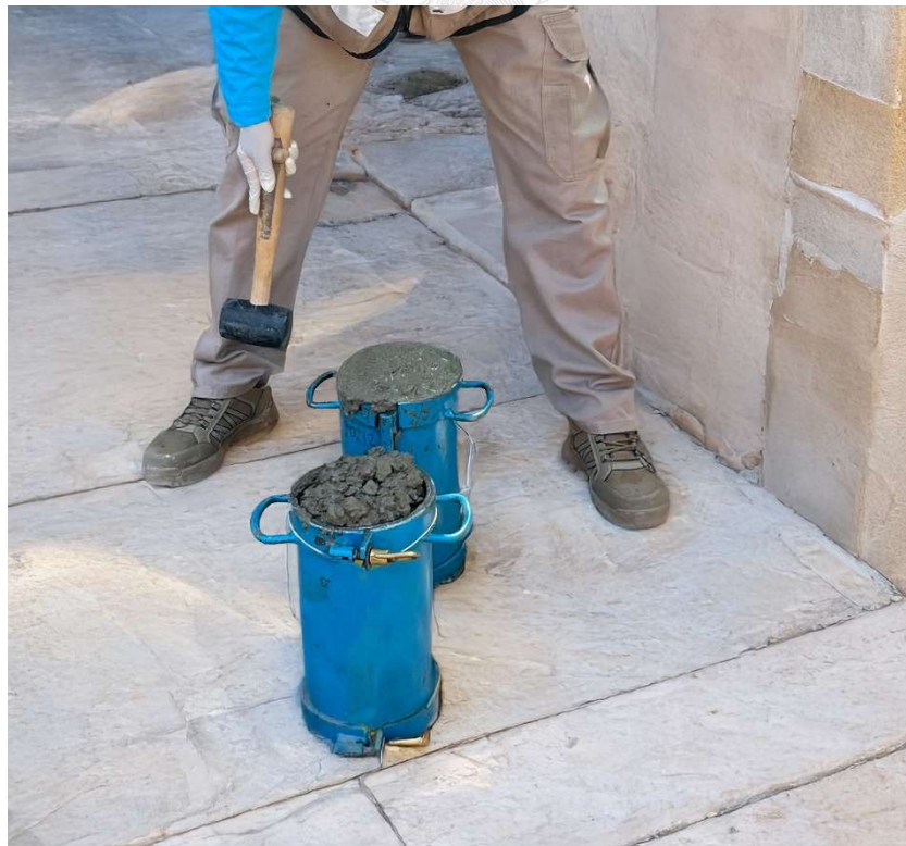
FIGURA 1.- Ejemplo de llenado de moldes cilíndricos
