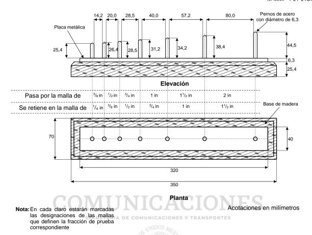
FIGURA 2.- Calibrador de longitudes
