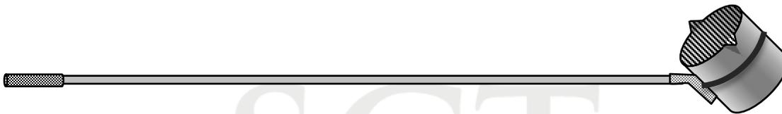
FIGURA 7.- Vaso muestreador
