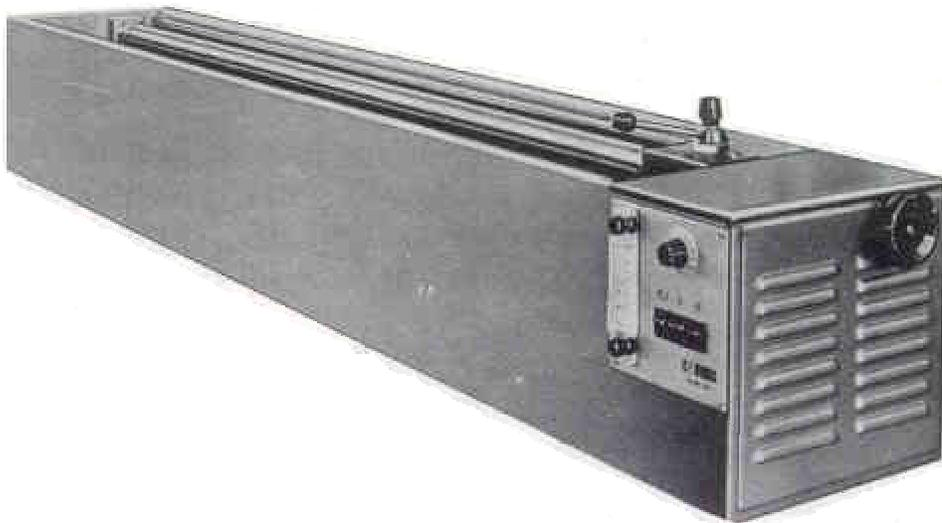
FIGURA 1.- Ductilómetro
