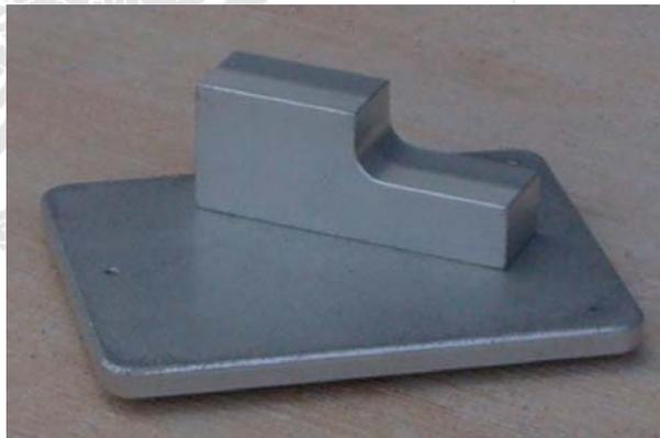
FIGURA 5.- Dispositivo para calibración de la escala vertical del perfilógrafo
