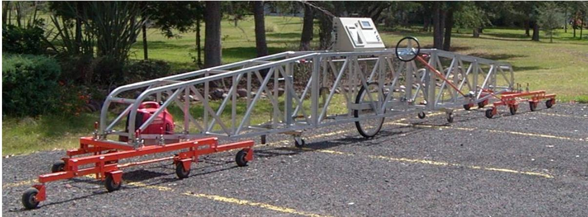
FIGURA 1.- Perfilógrafo tipo California
