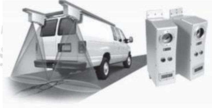
FIGURA 1.- Equipo escáner acoplado en vehículo
