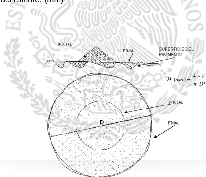
FIGURA 4.- Esquema del ensayo de Macrotextura (Norma NLT 335)
