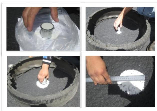
FIGURA 3.- Procedimiento de medición de Macrotextura
