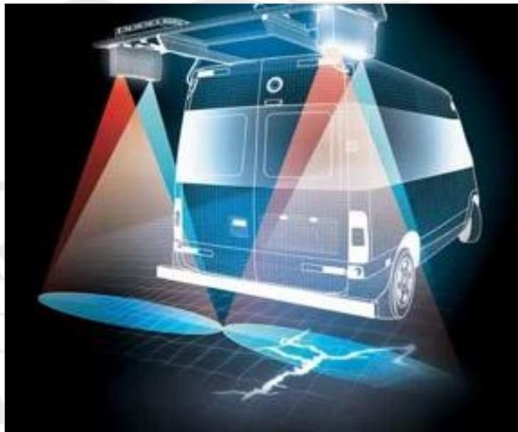
FIGURA 2.- Equipo laser acoplado en vehículo
