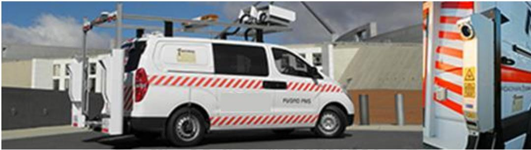
FIGURA 1.- Equipo óptico láser, acoplado en vehículo
