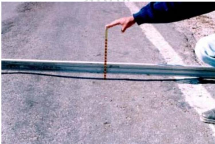
FIGURA 1.- Equipo para la determinación de la profundidad de [rodera][OSG1]
