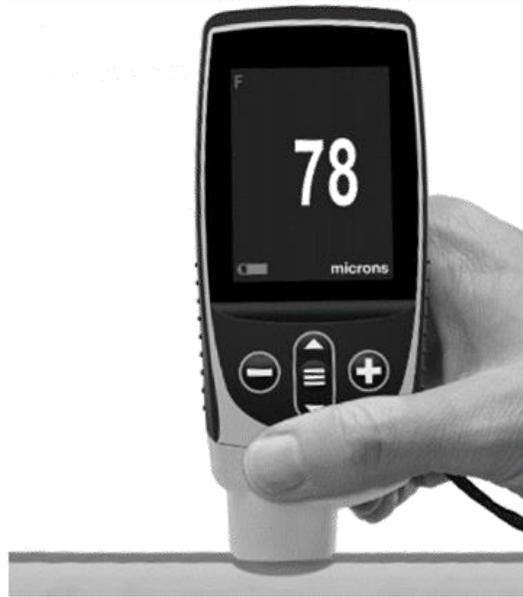
FIGURA 7.- Medición de espesor de la película de pintura en estado seco con medidor magnético
