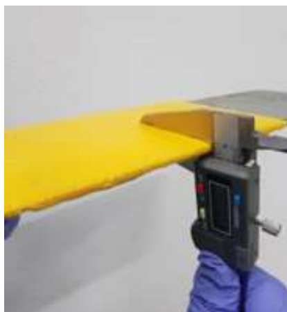
FIGURA 5.- Posicionamiento del vernier digital sobre la placa metálica con pintura termoplástica
