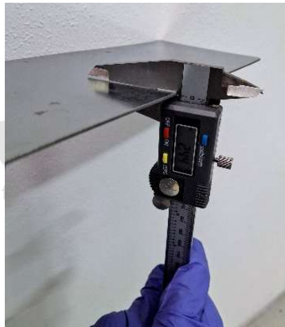
FIGURA 4.- Ajuste del vernier digital sobre la placa metálica
