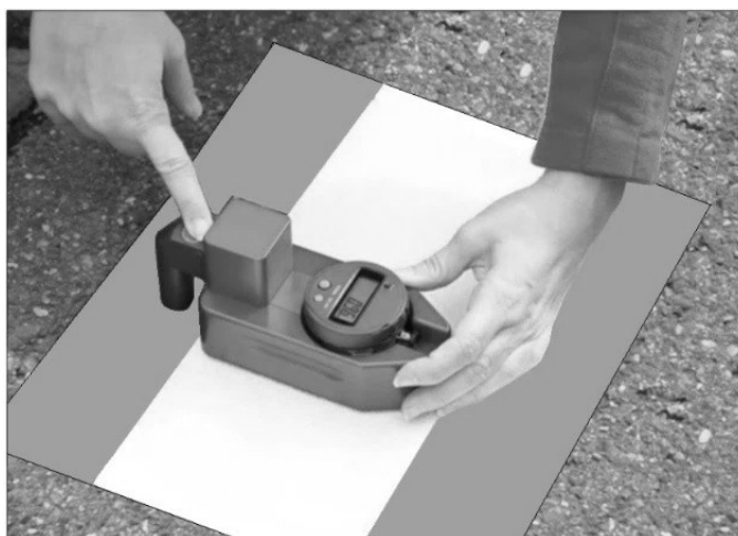
FIGURA 3.- Posicionamiento del micrómetro sobre la placa metálica con pintura termoplástica solidificada
