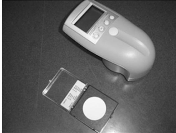
FIGURA 1.- Espectrofotómetro con cerámico de referencia
