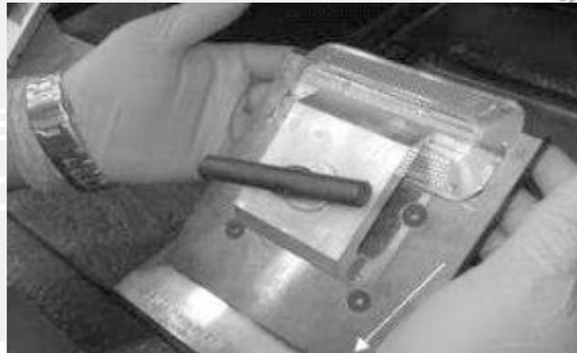
FIGURA 2.- Soporte para botón reflejante sobre el pavimento (DH-1)
