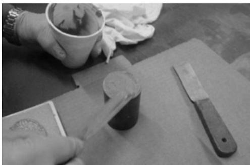
FIGURA 5.- Colocación del adhesivo en el cilindro
