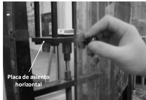
FIGURA 1.- Colocación del botón en la prensa
