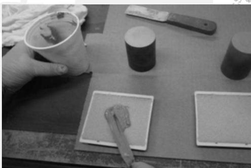
FIGURA 4.- Colocación del adhesivo en el botón
