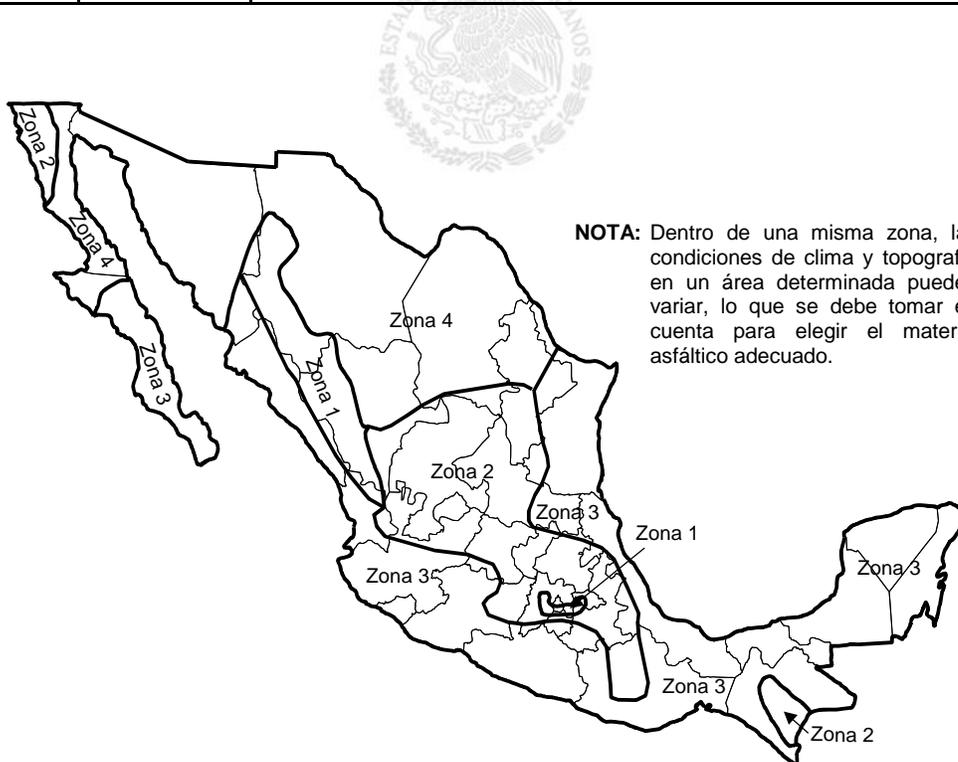
**FIGURA 1.- Regiones geográficas para la utilización de asfaltos clasificados según su viscosidad dinámica a 60°C**
