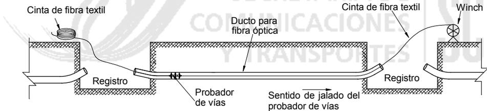
FIGURA 7.- Procedimiento para la prueba de vía
