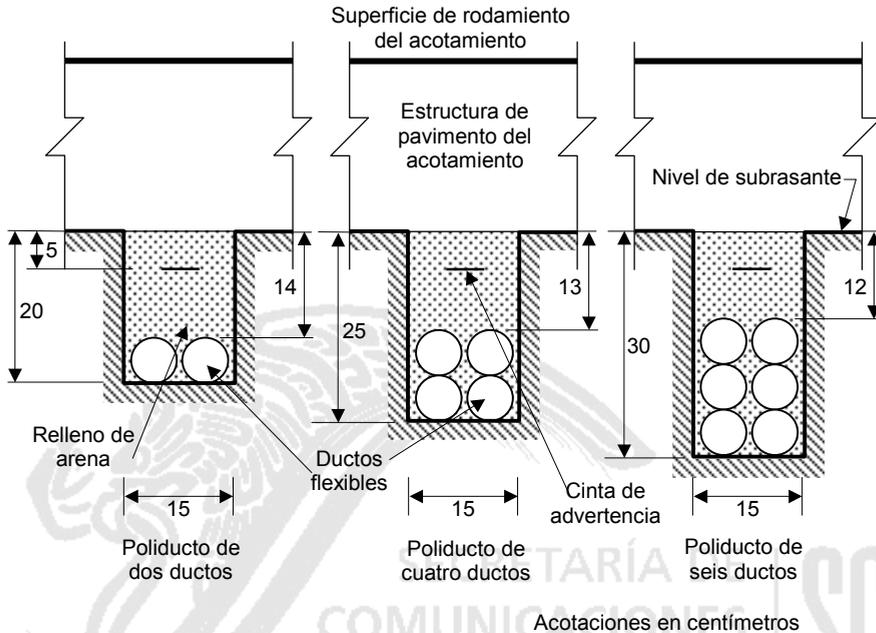
FIGURA 1.- Poliductos para fibra óptica en el acotamiento de carreteras
