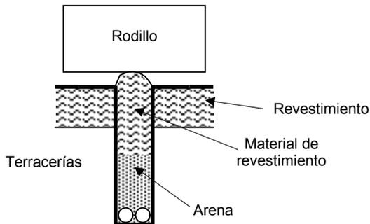
FIGURA 5.- Compactación mecánica del relleno
