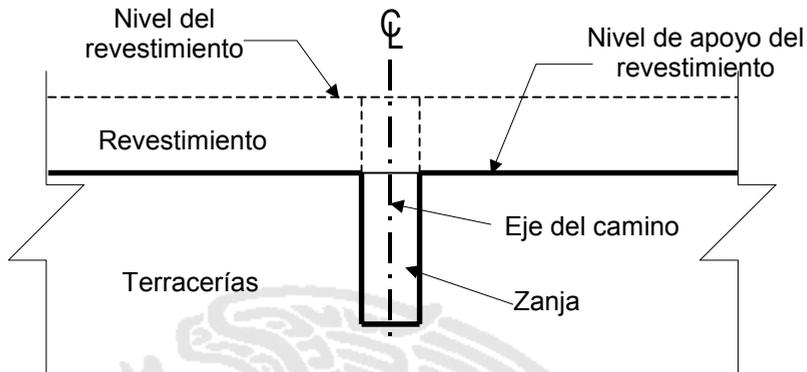
FIGURA 4.- Posición del eje del poliducto en caminos rurales
