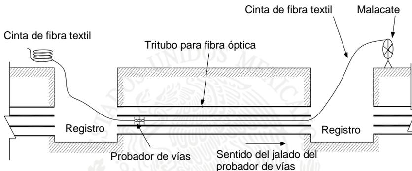
FIGURA 5.- Procedimiento para la prueba de vía
